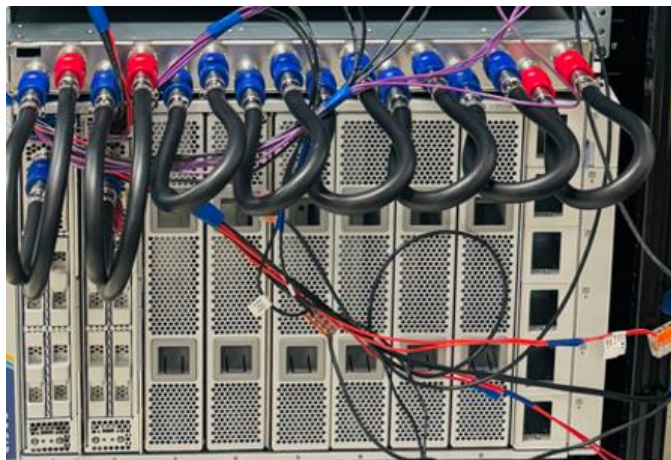
UCS-X i serwer x210 prototyp DLC open-loop
